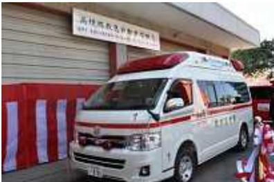
「トヨタハイメディック」という車種で定員7名。防振ヘッド、ストレッチャー、気道確保用資器材、酸素吸入器、自動心肺蘇生機など高度な機能を搭載します。
